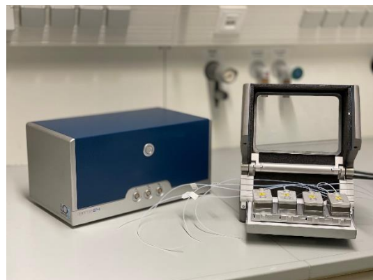
Photo of QCM-D instrument
